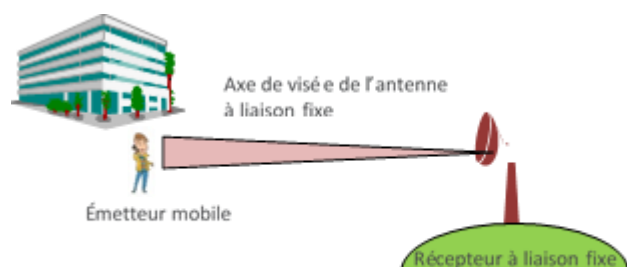
Figure 1: Exemple de scénario des pires conditions
