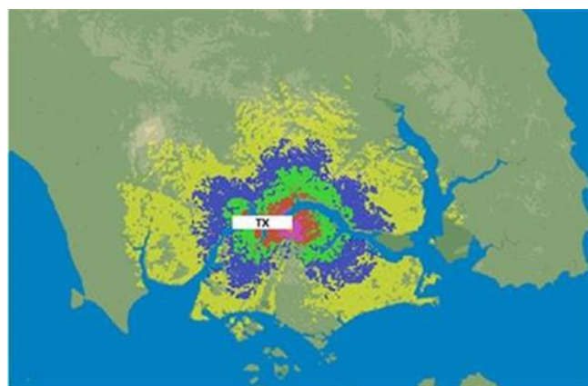
Figure 2: Exemple de résultat d'analyse de simulation sectorielle déterministe
